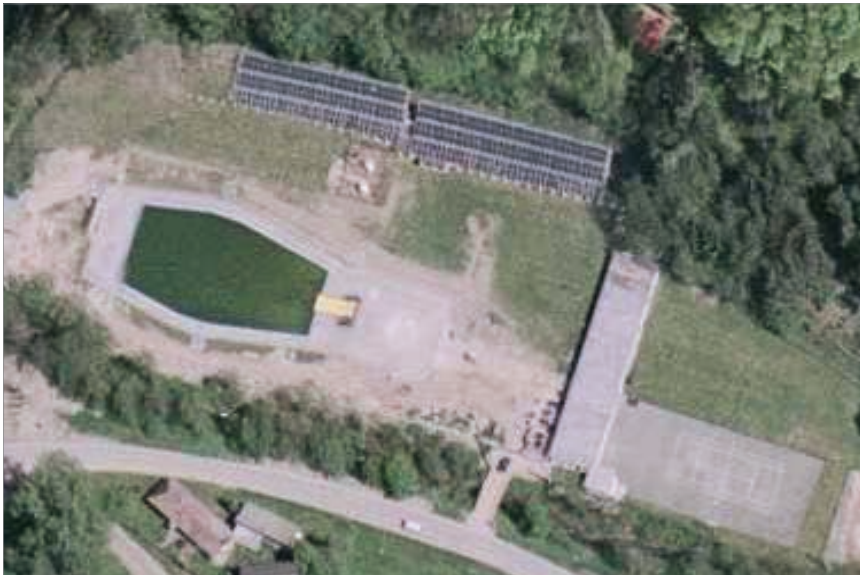
Vlevo satelitní snímek (© www.geodis.cz, © mapy.seznam.cz) areálu Regeneračního centra Podhostýnského mikroregionu, kolektorová pole v horní části. Vpravo nahoře: bazén s východní částí kolektorového pole, dole: strojovna bazénu.
