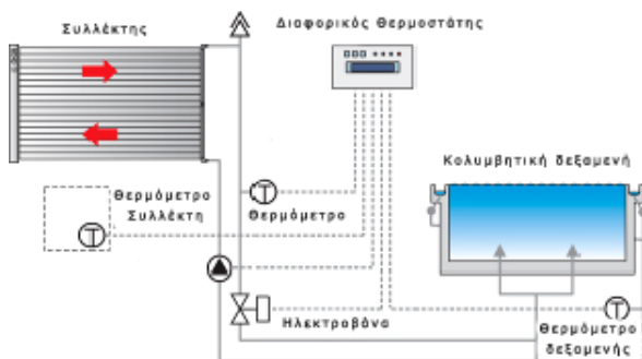
Εικόνα 4 Διάγραμμα κυκλώματος ενός συστήματος συλλεκτών μεγάλης κλίμακας
